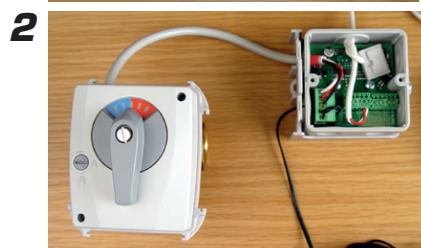
Montieren Sie die Platte (blau/rot) für die Positionsanzeige des Mischventils am Motor und befestigen Sie den Knebelschalter gemäß Abb. 3. HINWEIS Der Motor wird immer in mittlerer Position geliefert und das Rad passt nur auf die Position, in der sich der Motor befindet. Führen Sie die Schraube in die Mitte des Motors ein und ziehen Sie sie fest.
