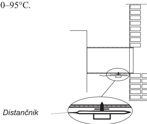
Na kotlih z nizkimi temperaturami dimnih plinov, se tipala namesti na stran ali na zgornji del dimne cevi brez distančnika.
